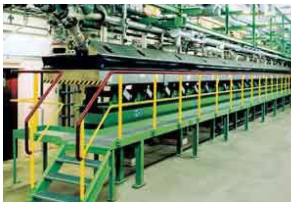
Vibrációs szállító a vegyiparban, 1,4 m széles 26 m hosszú
