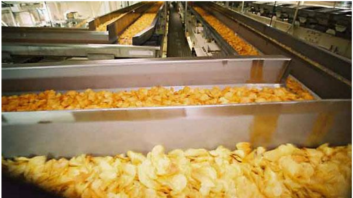
Vibrációs vályú 4000 kg óránként 120 m teljes szállítási hossz
